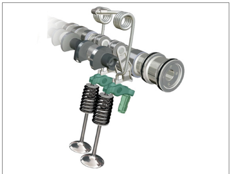
Photo 1: Vue d'ensemble du système du moteur Valvetronic de BMW
