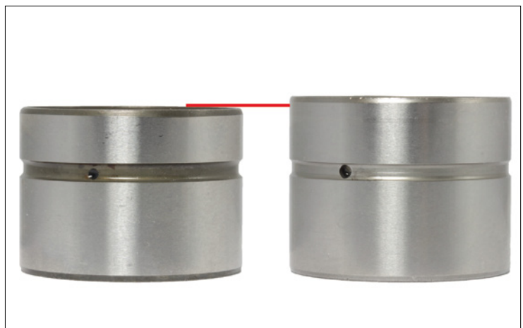
Photo 1 : poussoir hydraulique à attaque directe, à gauche - ancien modèle / à droite - nouveau modèle
