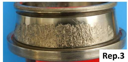
Une fusée endommagée entrainera un écaillage des pistes du roulement. (**Rep.3**)
