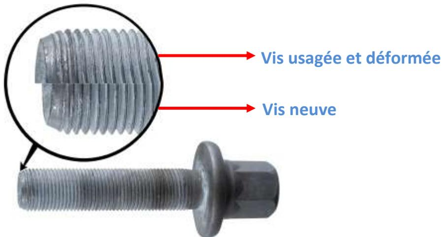
Cette déformation modifie définitivement les caractéristiques mécaniques des vis, et de ce fait "interdit" leur remontage.
