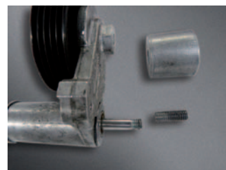
Poulie roue libre mesures sur le moteur diesel CR à 4 cylindres de Daimler
