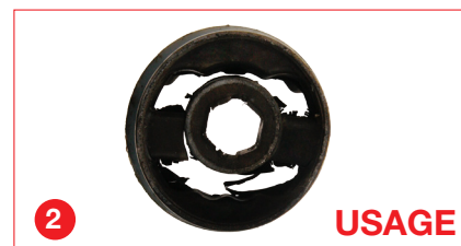
Silentbloc de bras de suspension défectueuse
