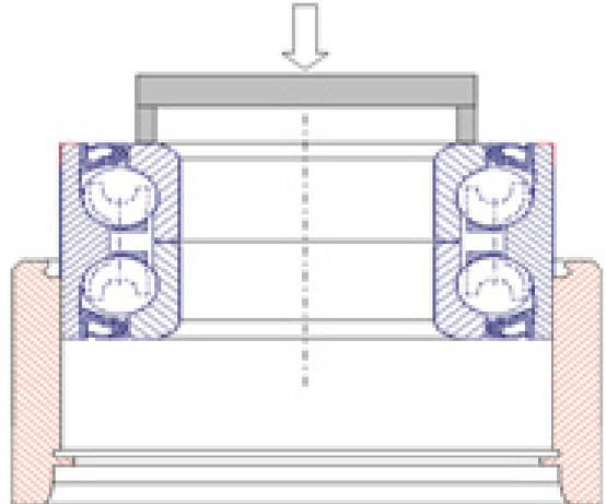
3. Monter le moyeu sur l'essieu puis serrer le nouvel écrou d'essieu au couple correct.
