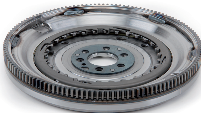
Photo 1 : Le nombre de dents de la nouvelle couronne de démarrage doit être identique à celui de l'ancienne
