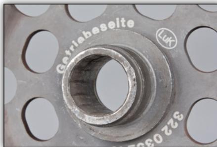
**Image 2 :** Profil de moyeu endommagé
